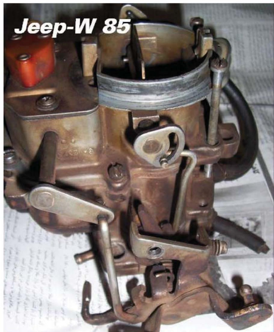
حالا میل دریچه کاملاً آزاده و از سمت راست به سمت بیرون میکشیدش!... وقتی کاربرات از رو ماشین باز شده و روی زمینه! میل کامل درمیاد!...
