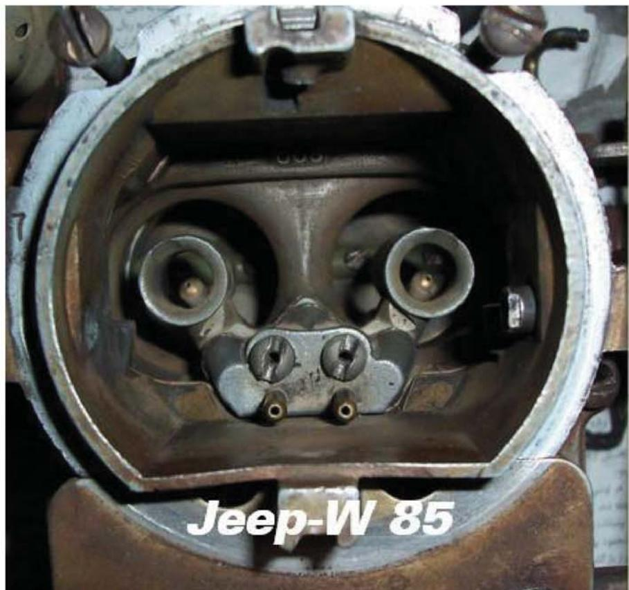
حالا به یه پیچ گوشتی دو سوی مناسب! اون دو تا پیچ رو باز می کنیم!... این پیچها، پیچهای کلاستر دریچه هستن ...!
