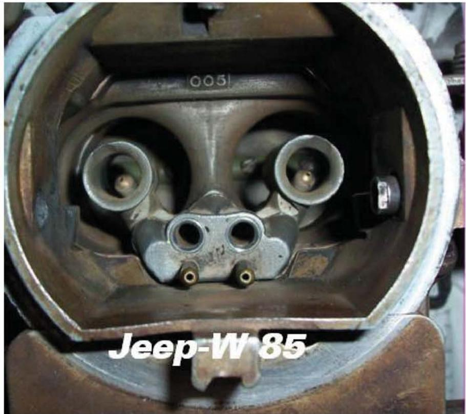
با باز کردن اون دو تا پیچ الان میتونید این قطعه رو بکشید بیرون!... با استفاده از یه
