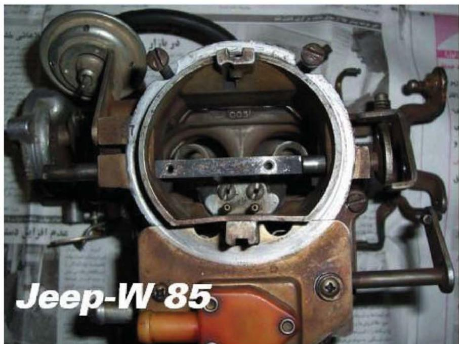
حالا میرید سراغ اهرمی که میل دریچه رو به گوشواره ریگلاژ دور تند سلو وصل کرده!... خار بالایی مهار اهرم رو در میارید و اهرم رو از میل دریچه جدا میکنید... با
